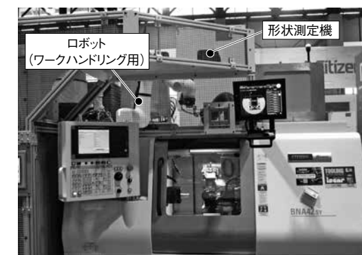
図2.6 加工後の計測・補正システム (Marubeni Citizen-Cincom)
