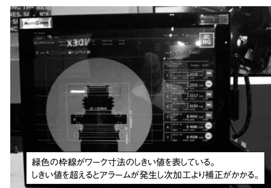
(a) 加工後のワーク形状測定+補正値更新
