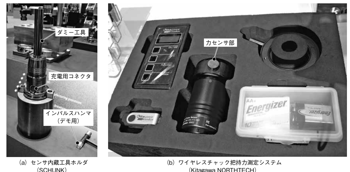
図2.3 センサ内蔵工具ホルダやチャック把持力測定システム
